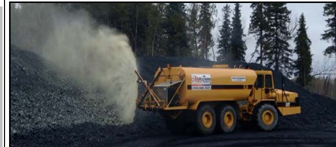
Application du scellant Soil-Sement sur une pile de charbon – améliorant la combustion et réduit la poussière.
